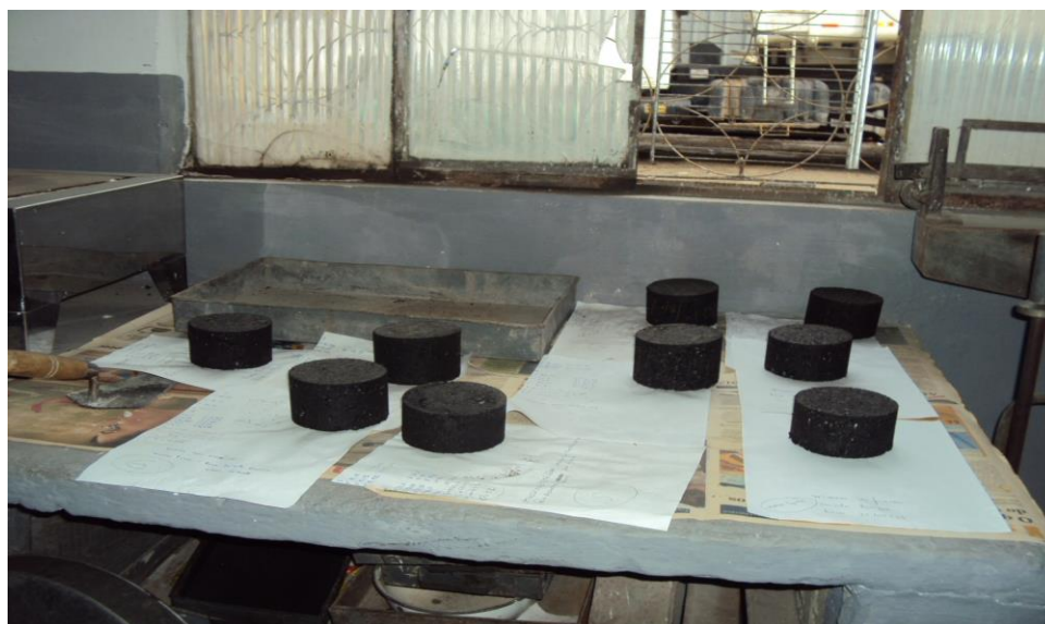
Figura 78 – Detalhe dos corpos de prova ensaiados para controle tecnológico do asfalto.
