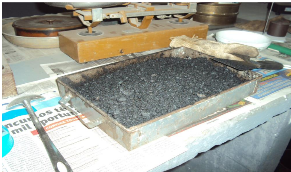
Figura 79 – Mistura asfáltica sendo preparada para posteriores ensaios.
