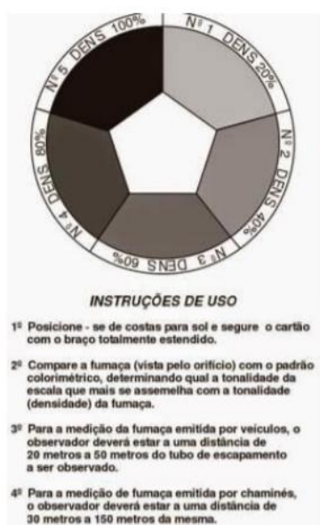
Figura 2 - Escala de Ringelmann para medição do índice de fumaça ( http://www.prevencaonline.net/2013/06/escala-de-ringelmann-monitoramento-de.html )
